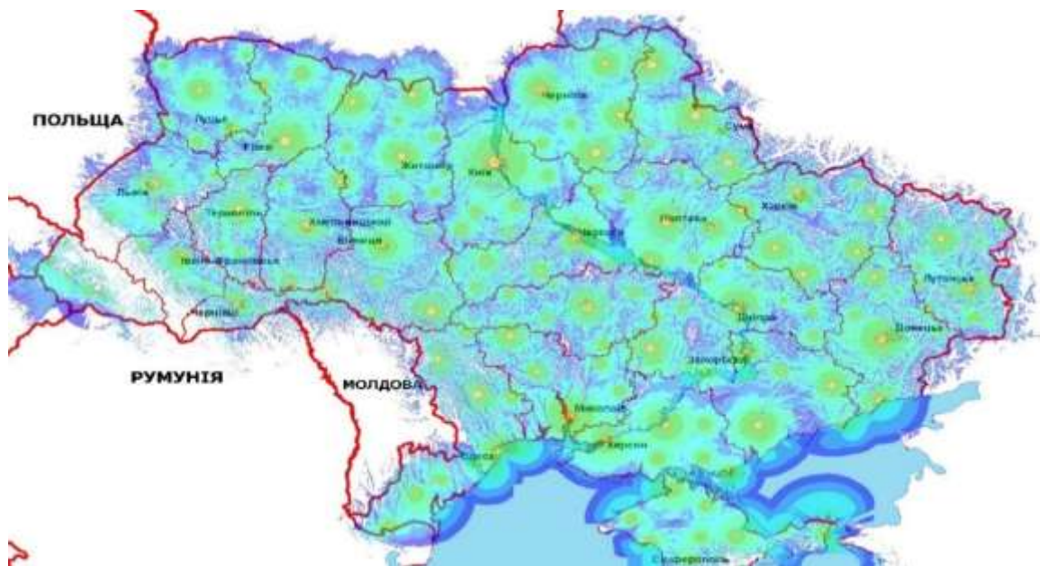
Рис. 6. Розрахункова (теоретична) карта покриття на прикладі одного з мультиплексів
