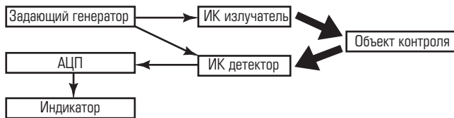
Рис. 2. Принципиальная схема инфракрасного эходефектоскопа
