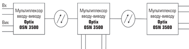
Рис. 1. Структурна схема мережі SDH провайдера
