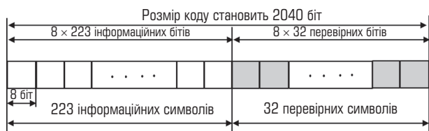
Рис. 11. Структура коду Ріда-Соломона (255, 223)
