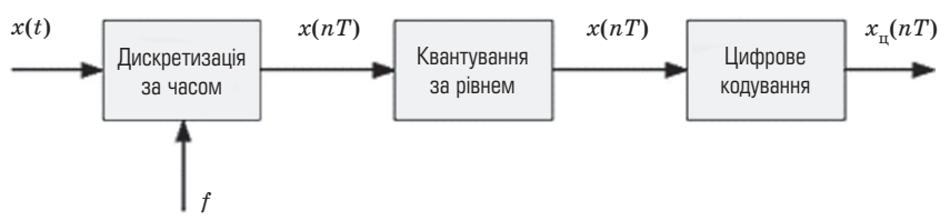
Рис. 1. Аналого-цифрове перетворення сигналу
