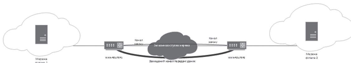
Рис. 2. Схема з розташованим на межі мережним обладнанням, підімкненим до публічної мережі
