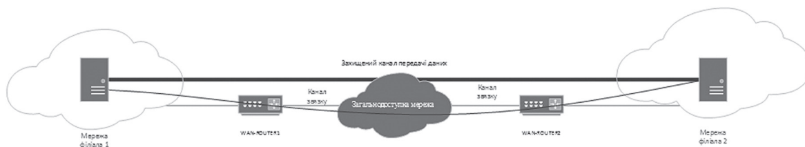
Рис. 1. Схема з кінцевими вузлами, що взаємодіють через публічну мережу
