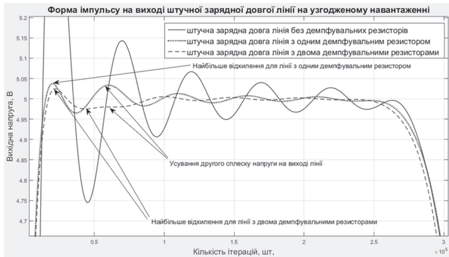
Рис. 4. Імпульс на виході штучної зарядної довгої лінії на узгодженому навантаженні у збільшеному масштабі
