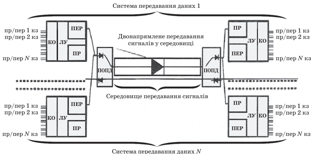
Рис. 3. Схема керованого ПОПД
