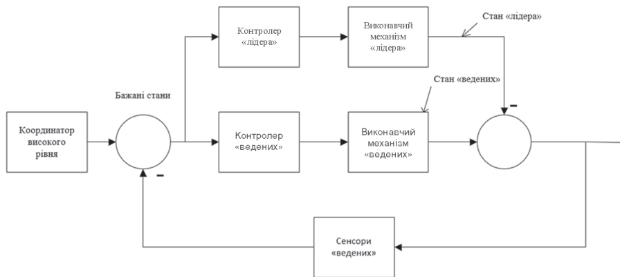
Рис. 1. Структурна схема методу керування «лідер-ведений»
