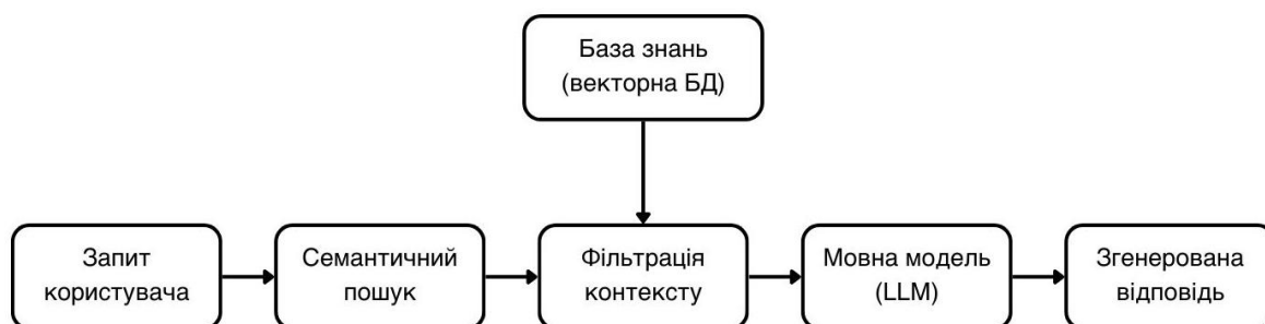
Рис. 1. Архітектура RAG-системи з фільтрацією контексту
