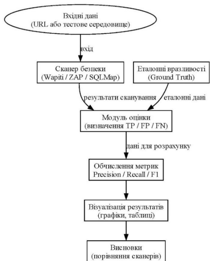
Рис. 1. Схема роботи моделі оцінки безпеки вебзастосунку з використанням Python-інструментів
