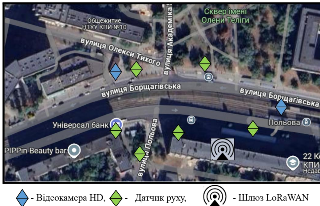
Рис. 1. Схема розміщення IoT-пристроїв на перехресті
